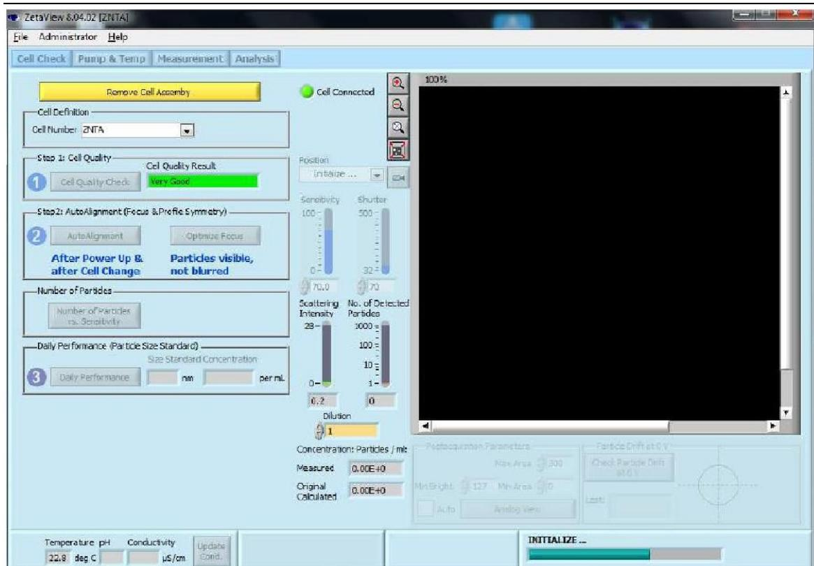
5. 初始化结束后软件弹出退化框，提示用泵冲洗管路，由于使用泵易产生气泡，因此点击“Skip”跳过此步骤。
