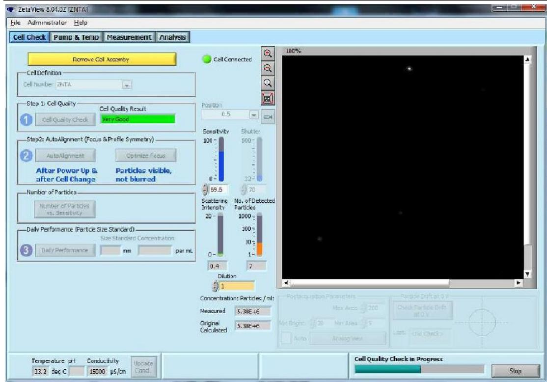
9. Zetaview 仪器开始执行 CellCheck (“Cell Quality Check in Progress“), CellCheck 的执行过程可以通过窗口右下角的进度条看到。
