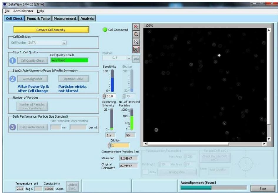
13. 然后进行聚焦优化（自动进行，无需手工操作，进度条显示）。
