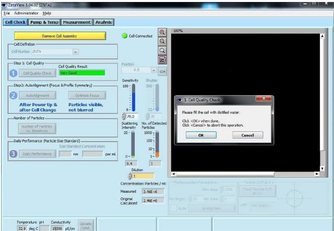
8. 使用注射器（5ml 或 10ml）匀速注射至少 5ml 蒸馏水（0.5ml/s 到 1ml/s）后，点击 OK.
